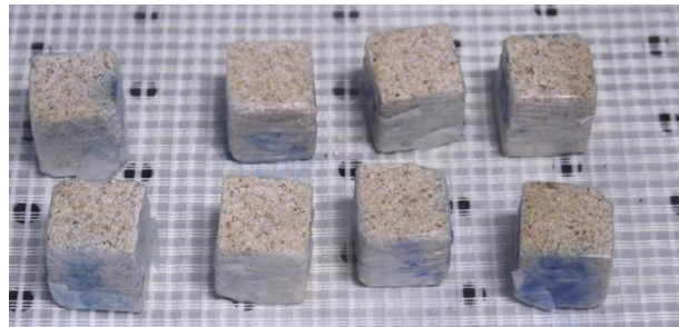
Argamassas a base de cal
